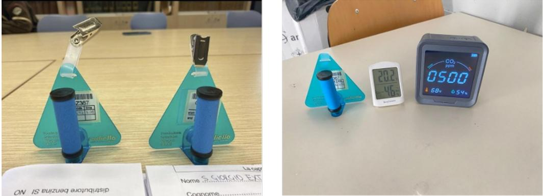
**Figura 1.** Campionatori passivi di NO<sub>2</sub> (sinistra); termoisgrometro e centralina di CO<sub>2</sub> (destra)
