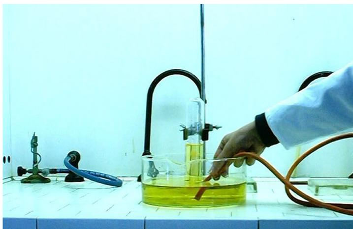
**Figura 2.** La raccolta in bagno pneumatico dei vapori derivanti dalla reazione tra rame e acido nitrico
